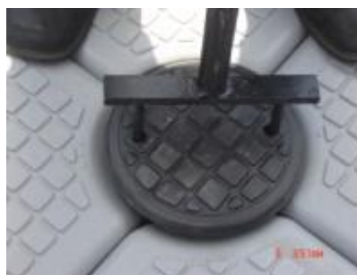
RUOTARE DI 45° IL CONNETTORE
