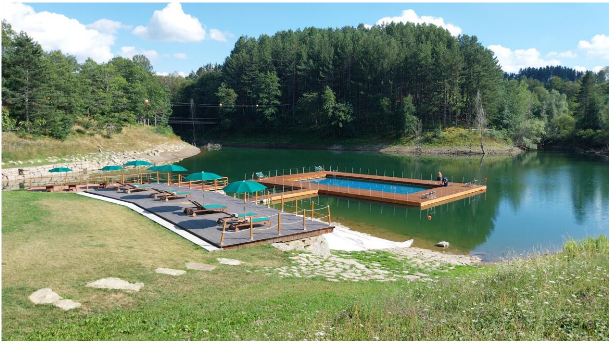
Pontile con piscina e fondo H 120cm realizzato con galleggianti Half-cubedock immersi
