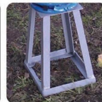
Supporto in acciaio per il fissaggio
