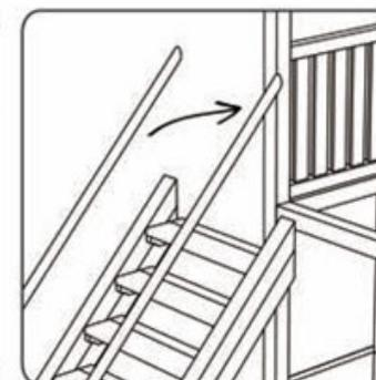
6 - Fissare la scala e i corrimano al corpo tramite viti
