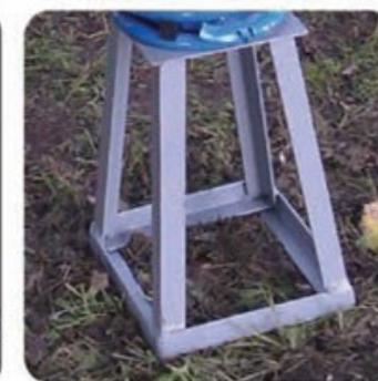
Supporto in acciaio per il fissaggio
