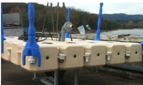
Piattaforma con telaio metallico e pompa immersa Platform with metal frame and submersible pump
